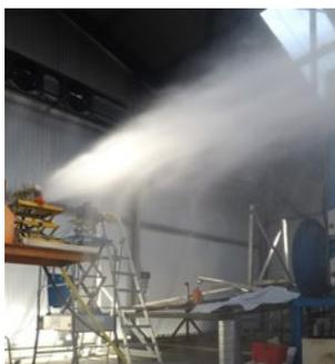
Fin 2020, le LCPP et le LEMTA (Université de Lorraine) ont quantifié la performance d'absorption radiative de la lance diphasique, à protéger le sapeur-pompier du rayonnement thermique.
